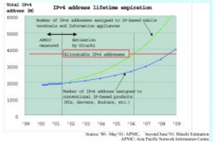
รูปที่ 2 การคาดคะเนการขาดแคลนหมายเลข IPv4 Address
